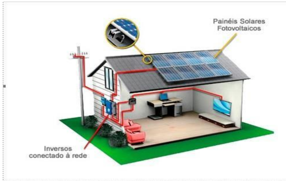
Figura 15 Sistema instalado com placas solar(BLUE-SOL,2014)
