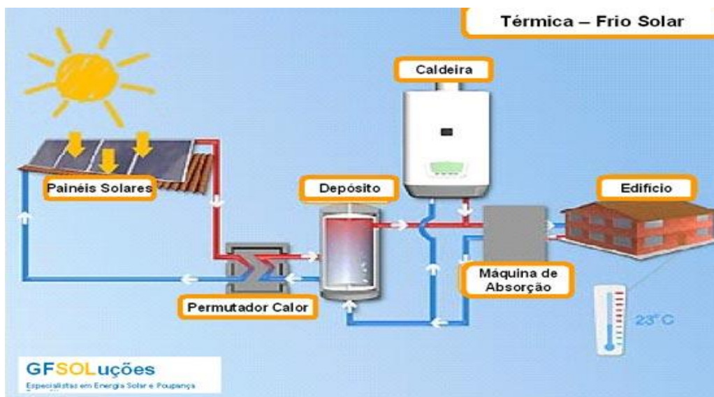
Figura 16 Funcionamento do sistema com placas solar. (FRIOSOLAR, 2013)
